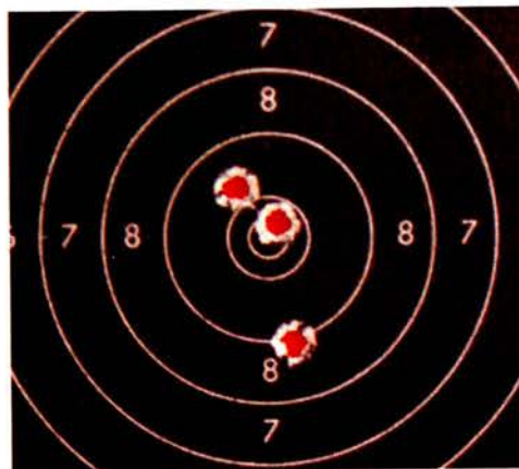
Figura 7. ( Este é um alvo correspondente à prova de tiro com carabina a 50 metros, e é o alvo estudado onde se verificam mais danos causados pelo projectil no rebordo da zona furada)
