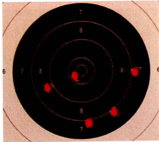
Figura 9. ( Este é um alvo correspondente à prova de tiro com pistola a 10 metros, é possível verificar que neste caso o projectil não causa tantos danos no rebordo da zona furada)
