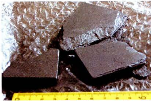
Figura 33 – Fragmentos de uma placa compactada com 30 ton.
