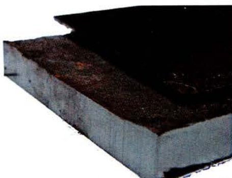
Figura 39 – Placa obtida na segunda série, 38% de cobre, com estratificação de camadas visível
