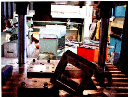
Figura 25 – Matriz e punção montados no porta ferramenta
