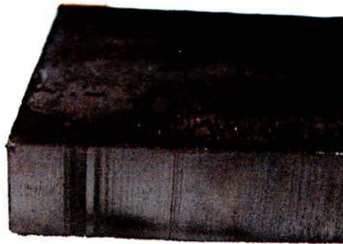
Figura 36 – Placa de grafite e 38% de cobre compactada com 80 ton e com ausência de defeitos visíveis
