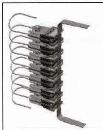
Figura nº9.8 - Interruptor com oito pares de IGBTs, de 20kV e de 600A, com arrefecimento líquido.[2]
