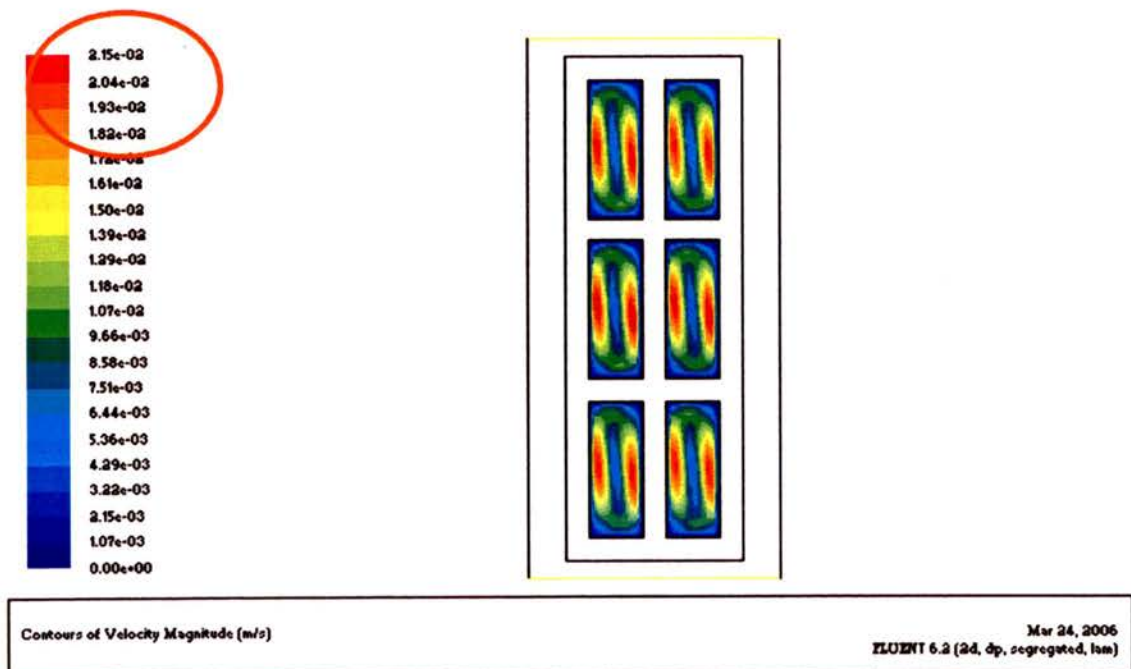
Figura 3. Mapa dos contornos da velocidade do ar que circula nos orifícios do tijolo
