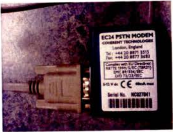
Figura 36. Modem e respectivo cabo de ligação ao contador
