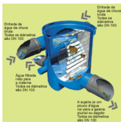
Figura A2.17: Funcionamento do Filtro “3P Volume Filter VF1”
