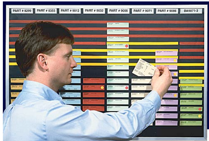
Figura 4 Sequenciador de produção com Kanbans
