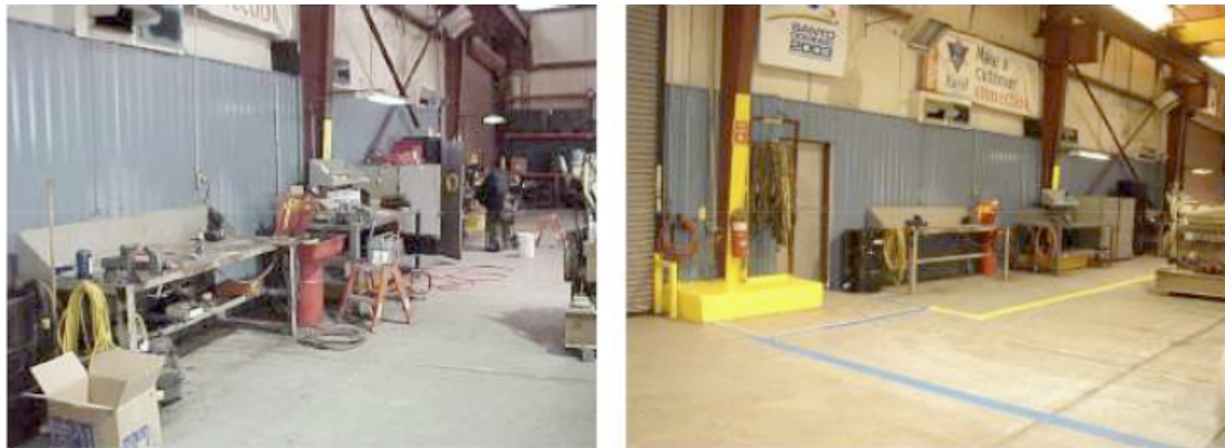
Figura 3 Chão de fábrica antes(esquerda) e depois(direita) de aplicar os 5Ss
