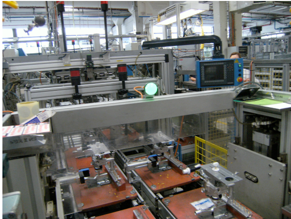
Figura 13 Luz indicadora da produção de um automático à saída da célula
