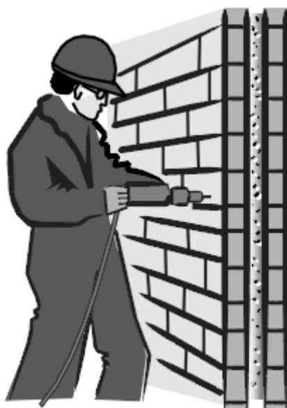
Fig. 2.10 - Injecção de isolante na caixa de ar [14]
