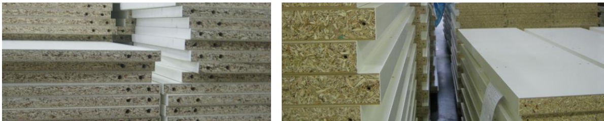
Figura 3.13 - Exemplo de semi-produto melamina e semi-produto BoF.
