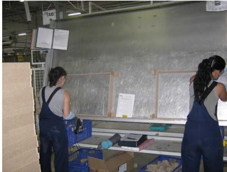
Figura 3.2 - Exemplo de uma banca de trabalho na zona dos frames (montagem de caixilhos).
