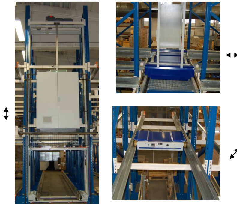
Figura 4.15-Sistema de movimentação dentro do armazém automático (elevador, carrinho e plataforma).
