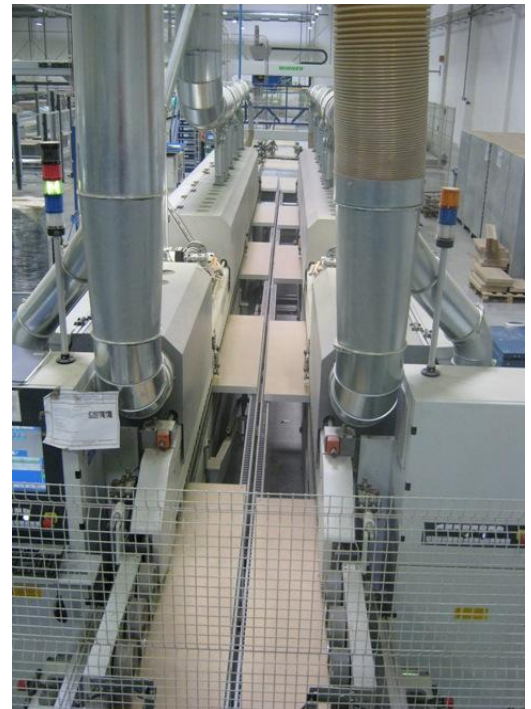
Figura 3.6 - Linha de orlagem e furação.
