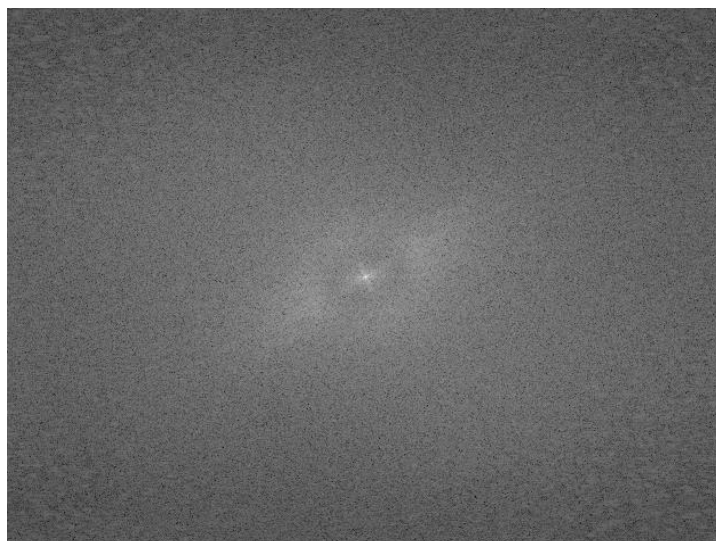
Figura 4.3 - Resultado da amplitude da Transformada de Fourier aplicado à imagem de couro preto capturada.
