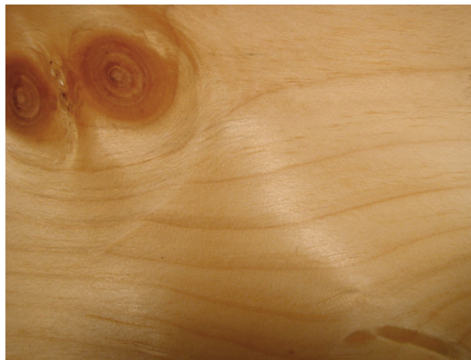
Figura 4.28 - Fotografia de uma porção de uma prancha de madeira de pinho com nós no canto superior esquerdo.
