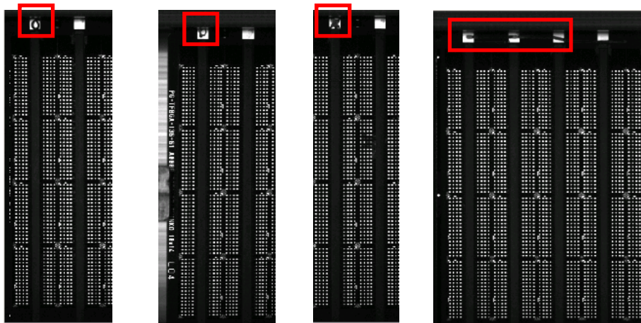
Figura 5.38 - Imagens de substratos não inspeccionados devido a marcações a caneta nas marcas localizadoras de bond channels (realce a vermelho das marcas não detectadas).
