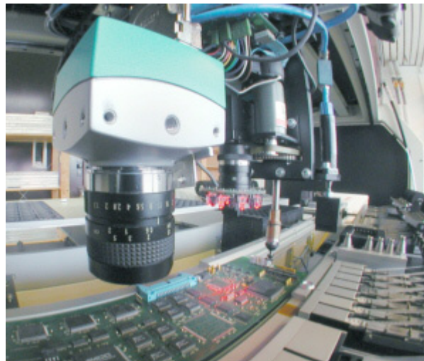
Figura 2.1 - Exemplo de aplicação de um sistema de visão industrial - neste caso aplicado a uma linha de montagem de circuitos electrónicos.
