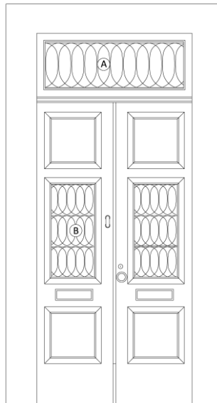
A – Bandeira com caixilho e grade em ferro B – Postigo com caixilho e grade em ferro
