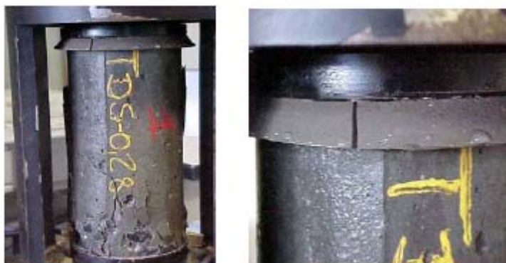
Fig.3.1. – Rotura prematura do capeamento de enxofre durante o ensaio
