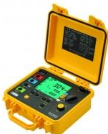
Figura A.1 - Aparelho para medição da resistividade do solo e da resistência de terra.
