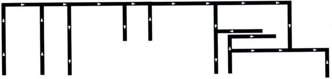
Figura 4.10 - Os diversos tapetes do sistema de movimentação presente no 'layout' fabril
