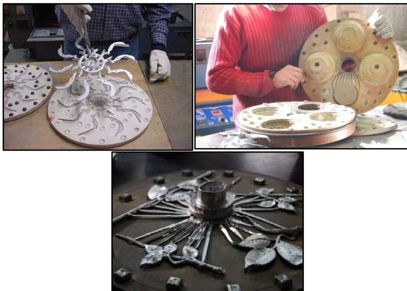
Ilustração 17 – a) Exemplo de um molde usado em fundição centrífuga [30]; b) Molde usado na Freitas & Doreis; c) aspecto das peças depois de desmoldadas
