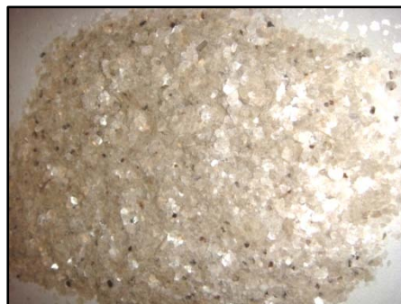
Ilustração 115 - Mica com a qual foi carregada a resina para o fabrico da base da fruteira
