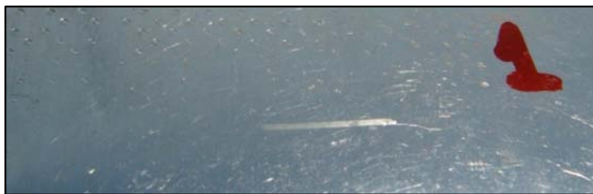
Ilustração 81 - Amostra de estanho para repuxamento após já ter passado por algumas etapas de laminagem a frio
