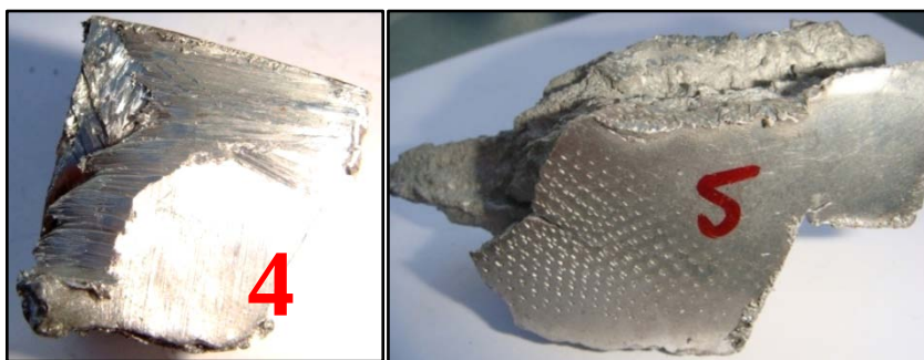
Ilustração 83 – a) Amostra usada para repuxamento, mas retirada de um lingote e ainda sem qualquer trabalho de laminagem; b) Amostra de estanho de uma empresa concorrente, usada no fabrico de medalhas
