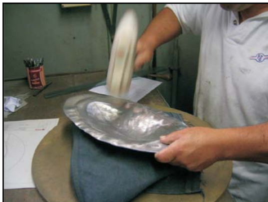
Ilustração 20 - Artesão a fabricar uma peça pelo processo de martelagem [31]
