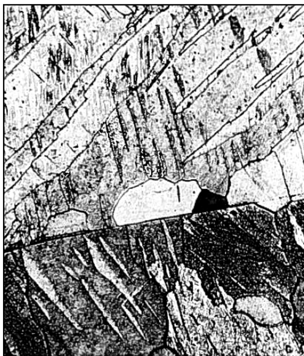
Ilustração 52 - Microestrutura de estanho puro, onde são visíveis recristalizações [35]
