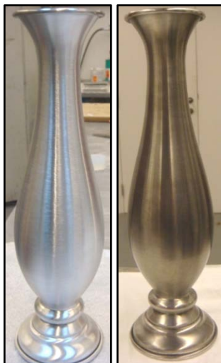
Ilustração 90 - a) Peça em estanho polida; b) A mesma peça que em a) só que com patine de escurecimento
