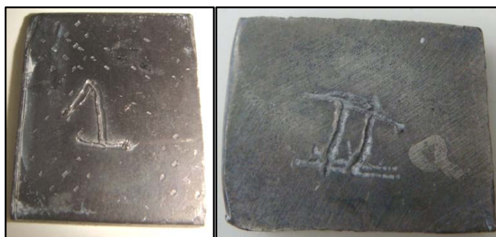
Ilustração 84 – a) Amostra I escurecida com a solução “a”; b) Amostra II escurecida com a solução “a”
