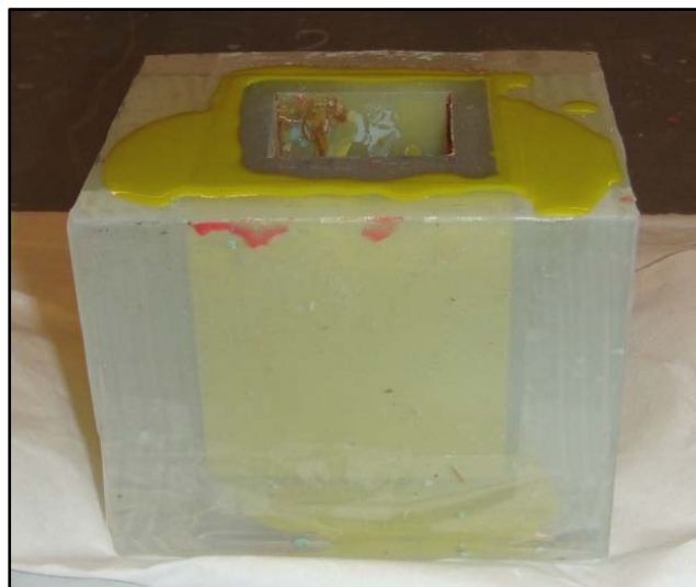
Ilustração 111 - Outra vista do molde preenchido, onde se consegue localizar através da transparência se o molde está bem fechado e se não se formaram bolhas de ar
