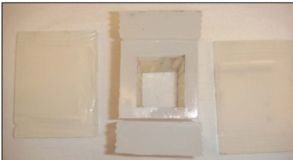
Ilustração 109 - Molde em silicone da peça a produzir, já cortada pelos seus planos de apartação
