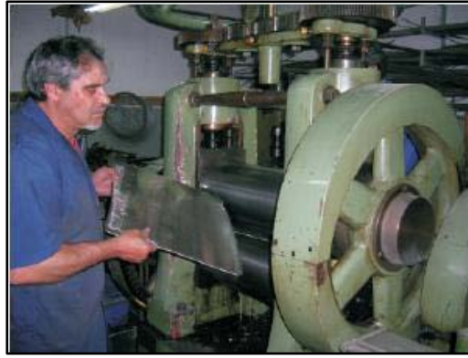
Ilustração 18 - Chapa de estanho a ser laminada para o posterior repuxamento [31]
