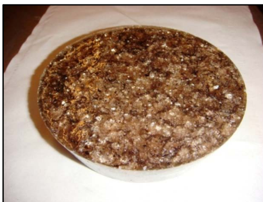
Ilustração 117 - Peça obtida, já desmoldada, curada e pós curada
