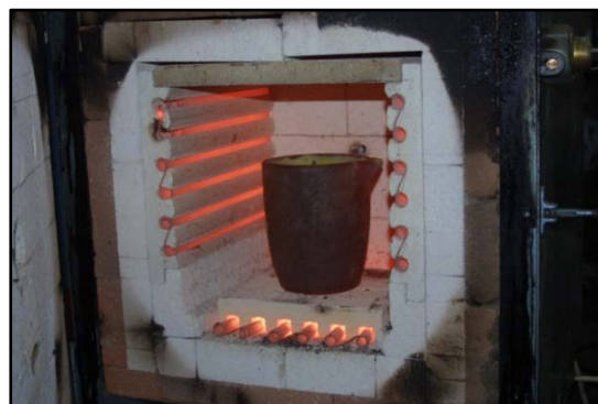
Ilustração 8 - Aspecto real de um forno eléctrico industrial [8]
