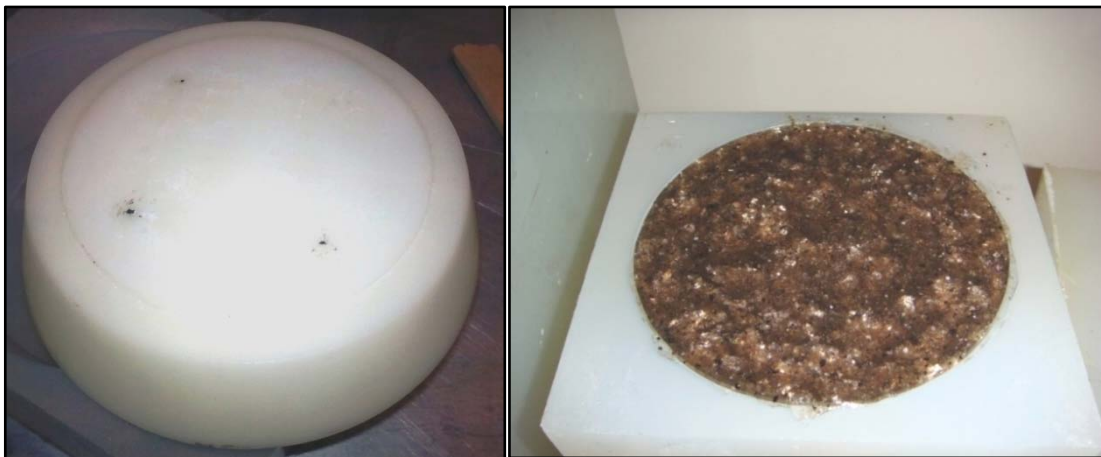
Ilustração 116 – a) Protótipo da base da fruteira; b) Base da fruteira já vazada no molde e em processo de cura
