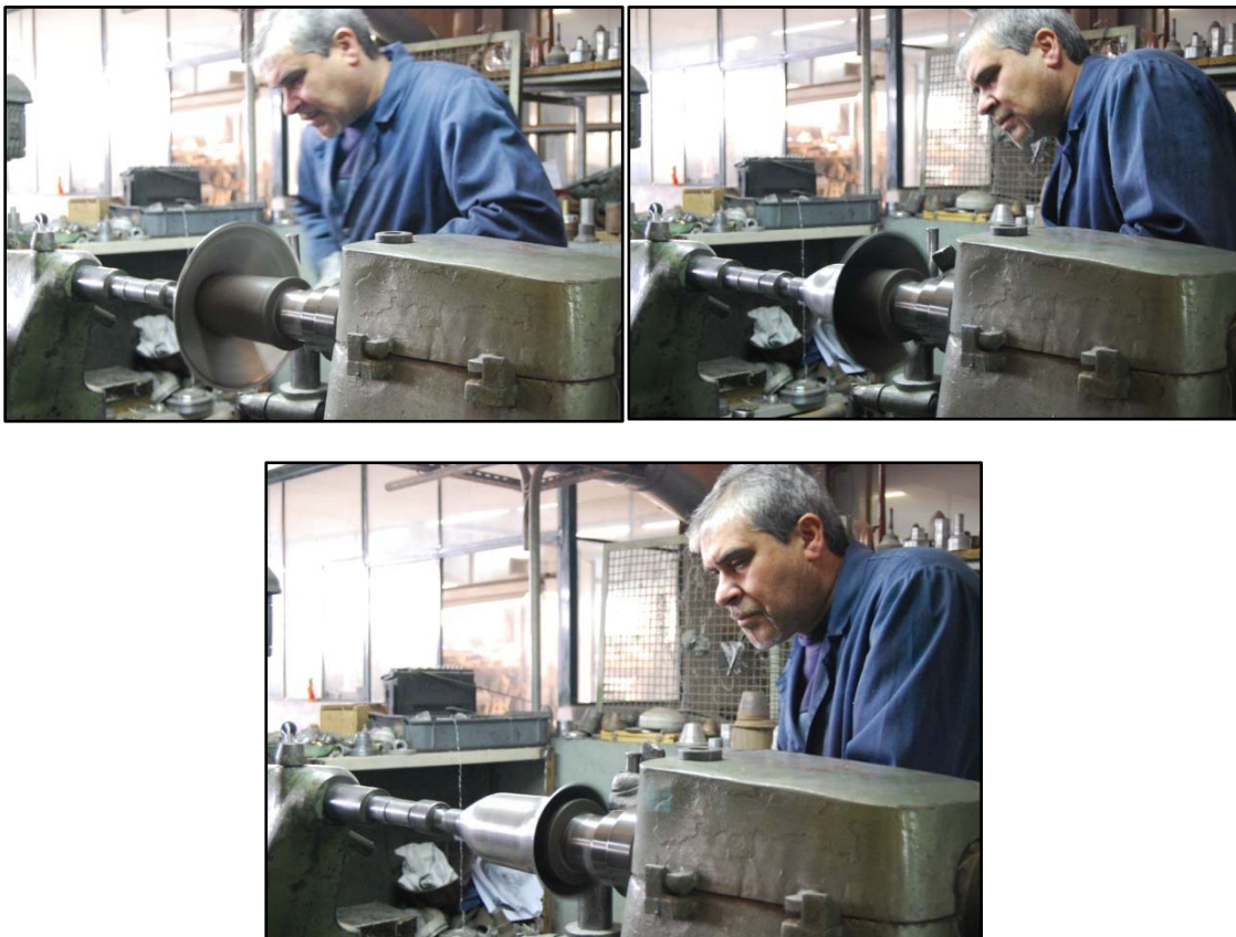
Ilustração 19 - Operário a executar uma peça por repuxamento nas várias etapas até próximo da forma final da peça
