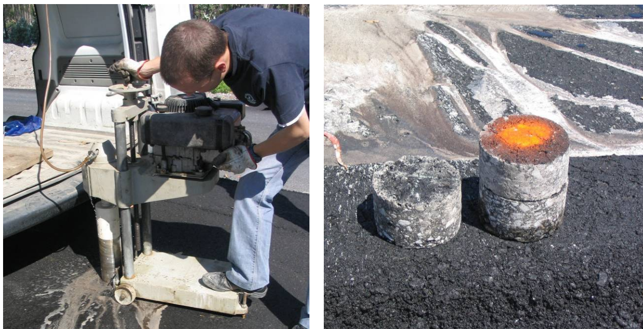
Figura 5.5 – Extracção dos carotes do pavimento
