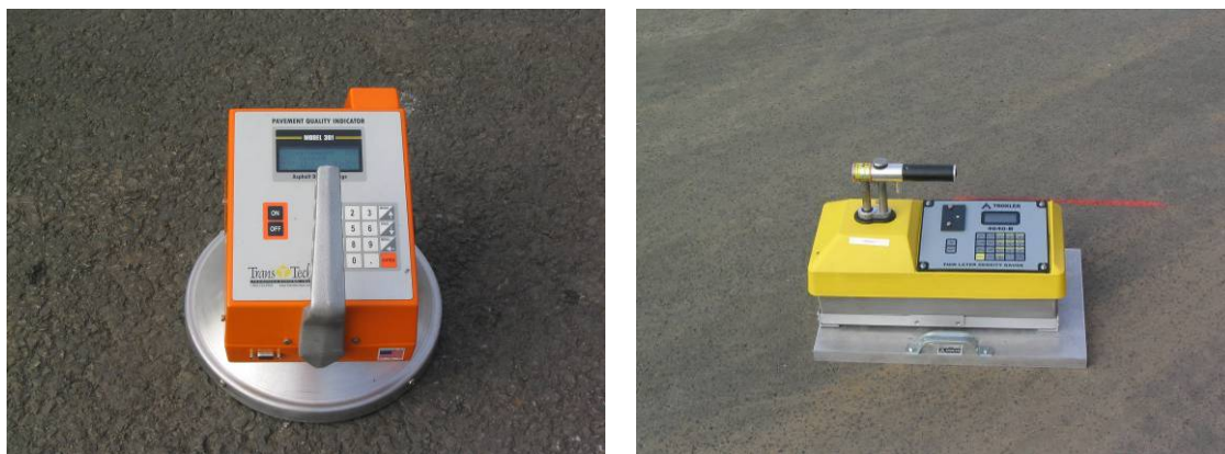
Figura 3.1 – Fotos dos equipamentos PQI e Troxler
