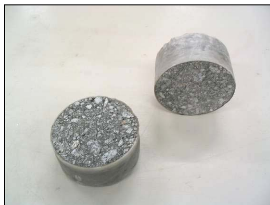
Figura 4.46 – Variabilidade da porosidade nos provetes moldados em laboratório sem compactação
