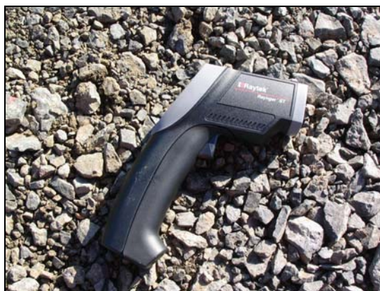
Figura 3.8 – Foto do equipamento de medição da temperatura (pistola de infravermelhos)
