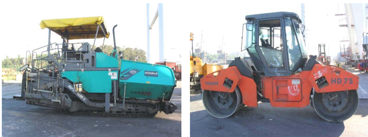
Figura 5.2 – Cilindro HAMM HD 75 e pavimentadora Vögele Super 1600-1
