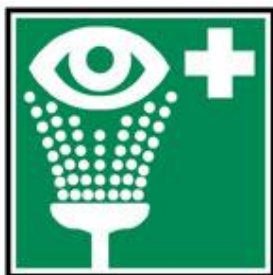
Fig.2.18 – Indicação de dispositivo lava-olhos de emergência
