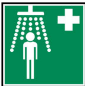
Fig.2.17 – Indicação de chuveiro de emergência
