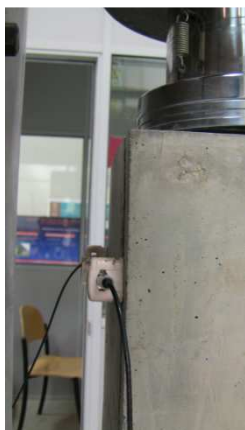
Fig.4.15 – Apresentação de uma grande fenda à esquerda junto do lvdt
