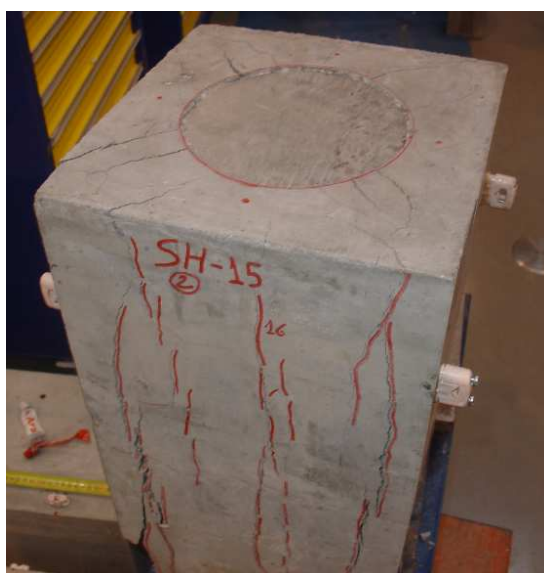
Fig.4.26 – Pormenor do esmagamento do betão na zona de contacto com a placa de carregamento
