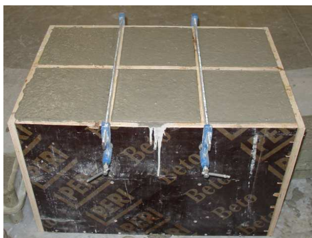
Fig.3.3. – Fim da betonagem dos modelos
