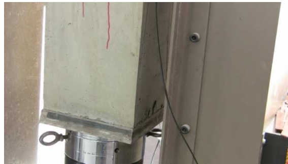
Fig.4.8 – Fendilhação na base devido à elevada compressão
