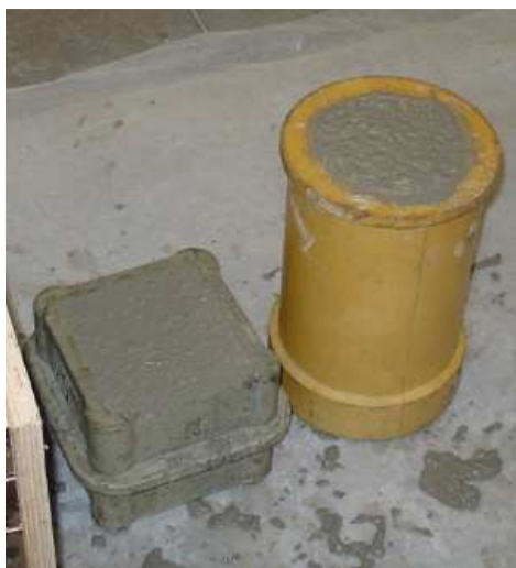
Fig.3.12. – Provetes cilíndricos e cúbicos para medir as características do betão segundo as normas
