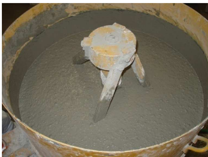
Fig.3.11. – Execução da amassadura do betão usado nos modelos
