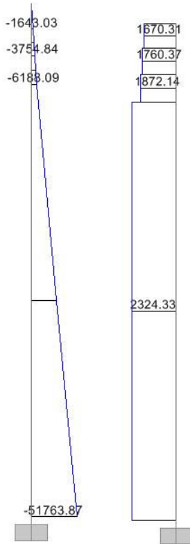
Figura 3.7a – Diagramas de M_{Ed} [kN.m] (à esquerda) e V_{Ed} [kN] (à direita) do pilar P2 para um comportamento limitadamente dúctil.
