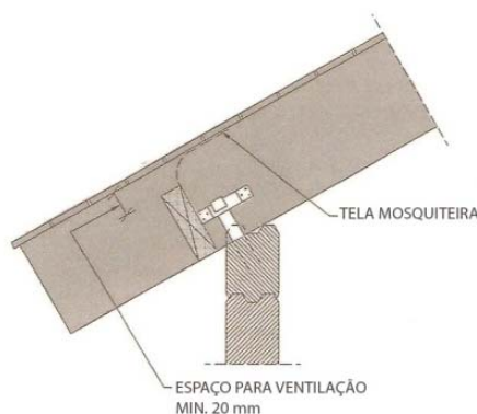
Fig.3.23 – Pormenor da ventilação da cobertura [3]
