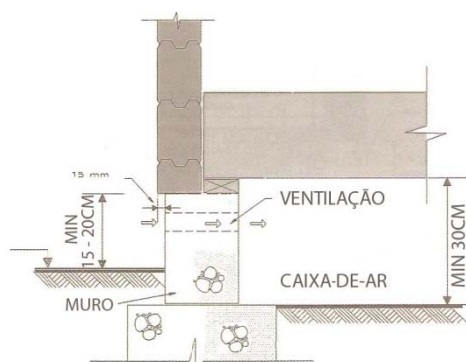
Fig.3.5 – Pormenor construtivo da parede [3]
