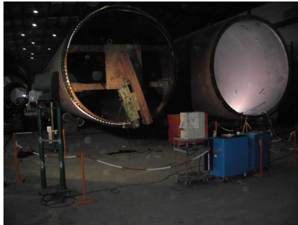
Figura 31 – Flange a ser mecanizada
