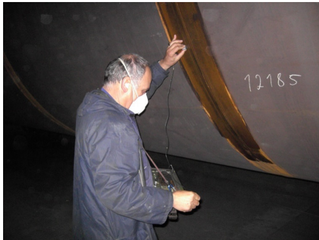
Figura 28 – Inspeção de Ultra-Sons a um troço
