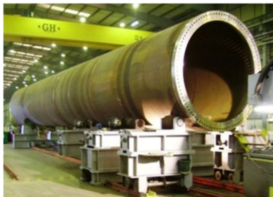
Figura 20 – Armação de um troço de uma torre eólica
