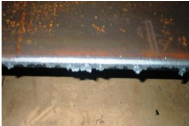
Figura 13 – Chapa proveniente do corte contendo escória na zona de corte
