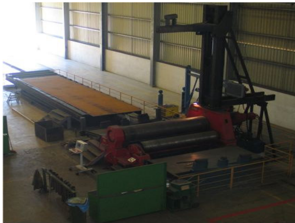
Figura 16 – Chapa em posicionada em cima da mesa da Calandra
