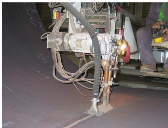
Figura 18 – Soldadura longitudinal interior de uma virola
