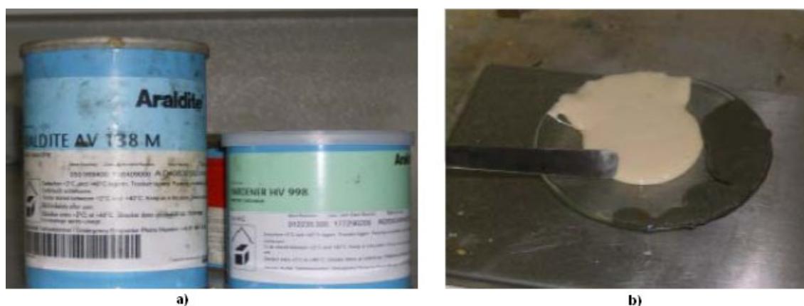
Figura 21 – a) Recipientes da resina AV 138M e do endurecedor HV 998. b) Mistura dos dois componentes (resina bege, endurecedor cinza)
