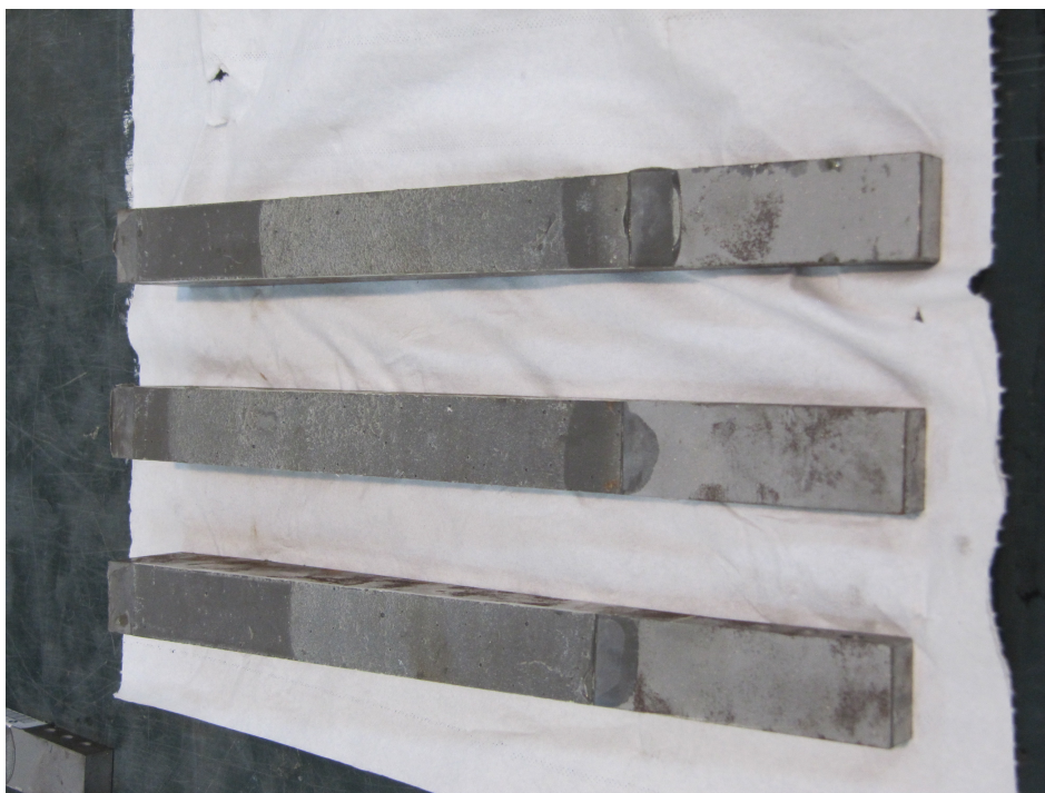
Figura 43 – Roturas coesivas do adesivo AV138 para o ensaio ATDCB
