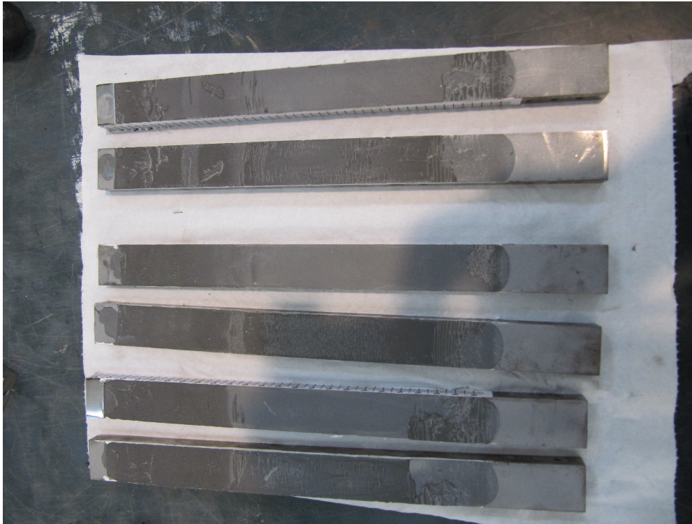
Figura 32 – Roturas coesivas no adesivo AV138
