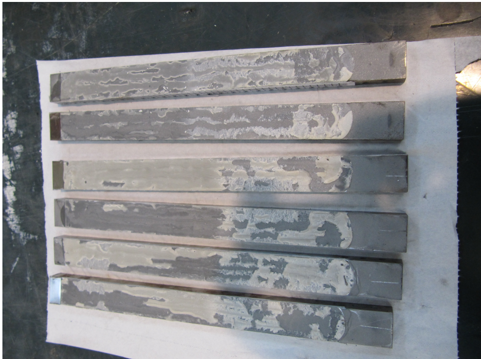
Figura 39 – Roturas interfaciais no adesivo 2015
