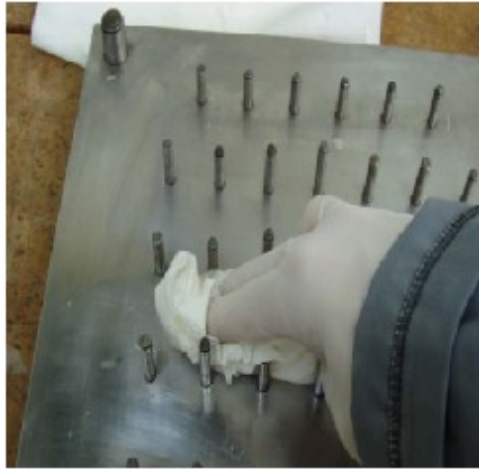
Figura 17 – Limpeza do molde.
