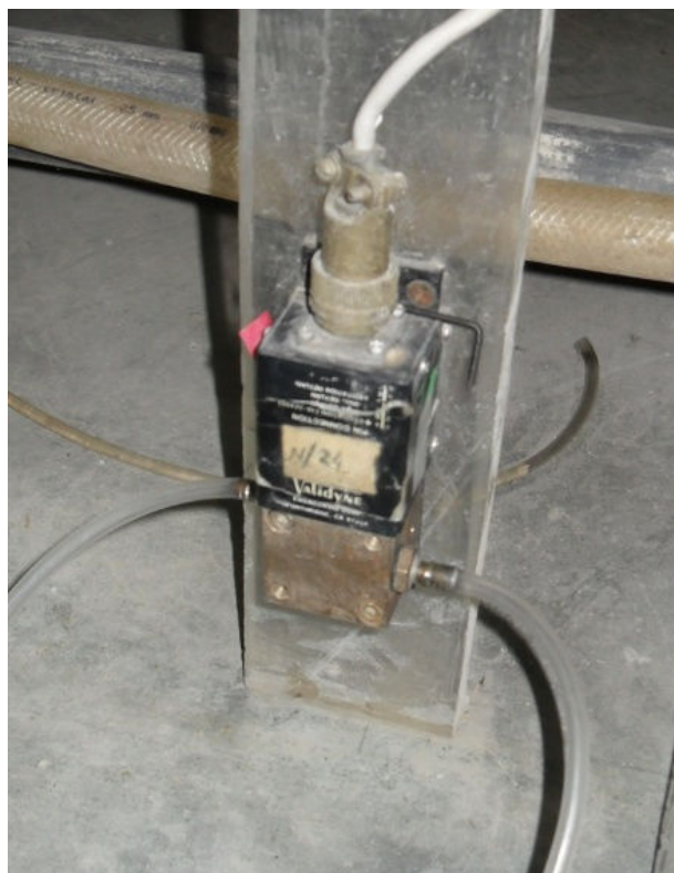
Figura 3.14. - Transdutor diferencial de pressão utilizado
