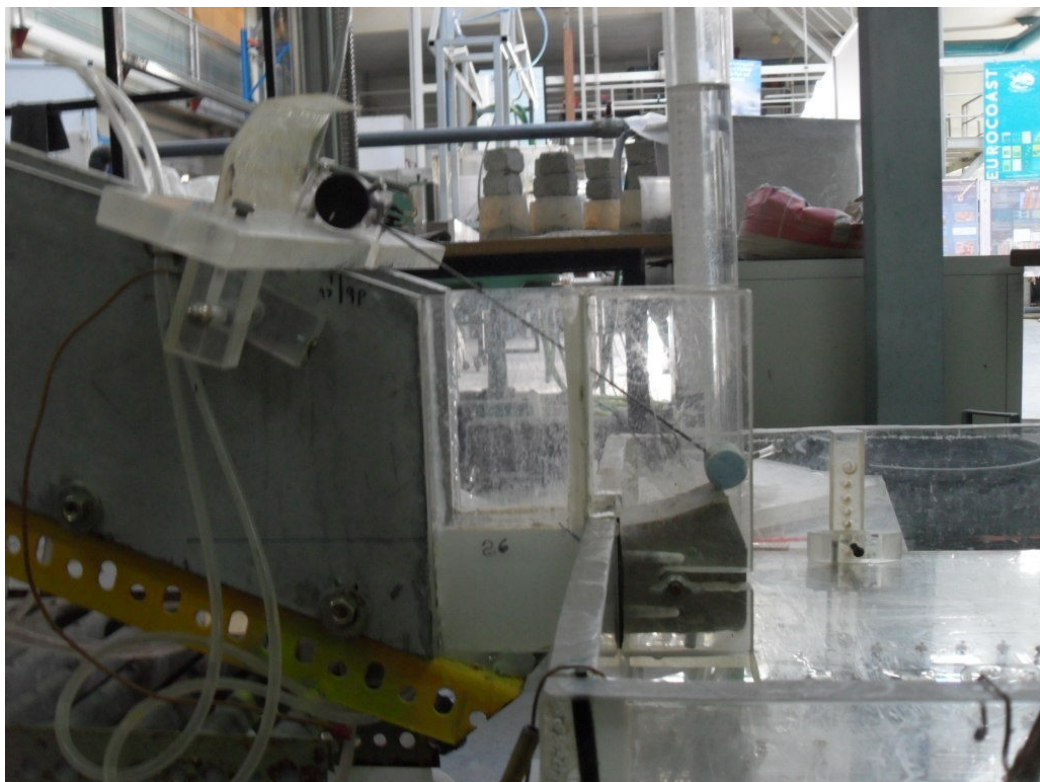
Figura 3.21. – Sistema Flutuador/Potenciômetro ligado aos adaptadores ajustáveis
