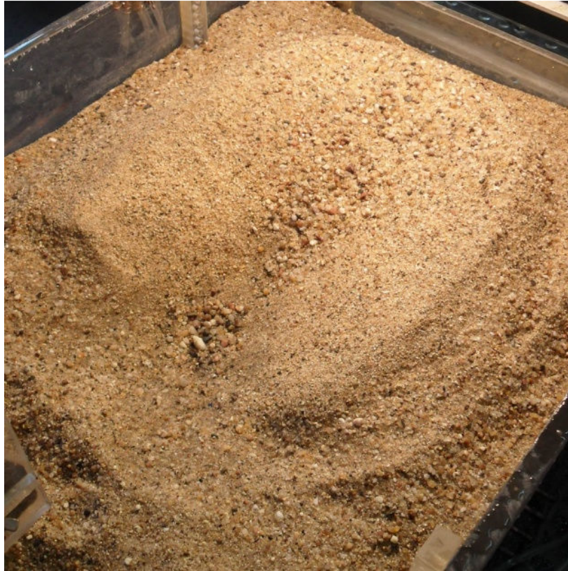
Figura 3.25. – Fossa de erosão com realimentação
