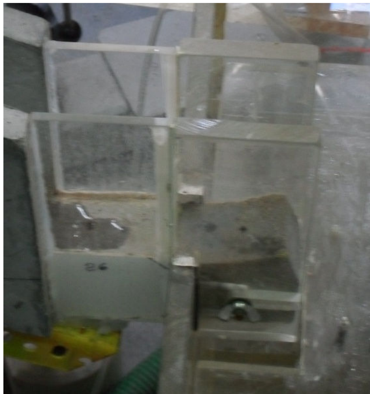
Figura 3.18. - Pormenor do trampolim com tomada de pressão
