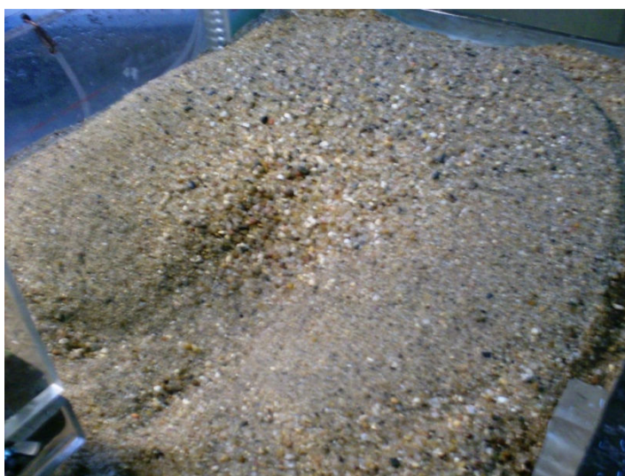
Figura 4.37. - Aspecto final do leito após ensaio onde a altura do colchão de água foi um factor condicionante da altura da barra
