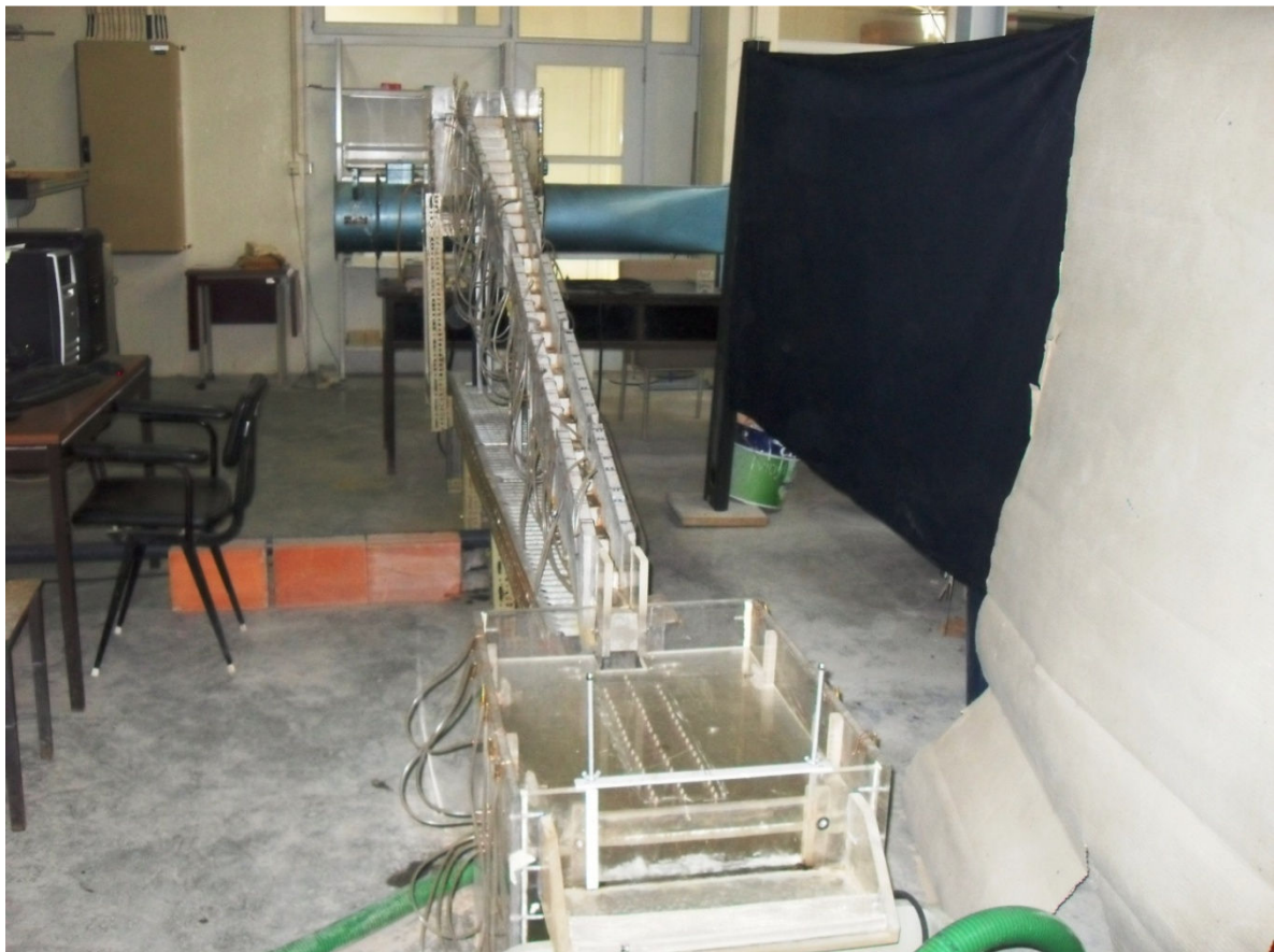
Figura 3.1. - Vista geral do descarregador de degraus
