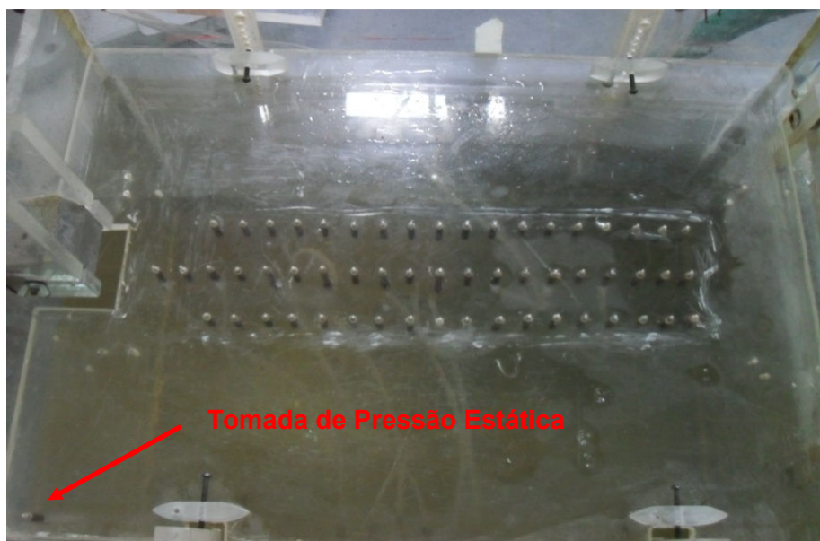
Figura 3.9. - Placa de perspex representativa do fundo fixo
