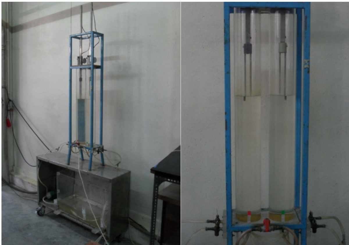
Figura 3.30. – Instalação utilizada para calibração do transdutor diferencial de pressão (à esquerda) e pormenor do aparelho utilizado para leitura dos níveis de água (à direita)
