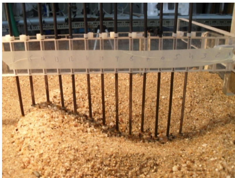
Figura 3.23. - Exemplo de medição das fossas de erosão
