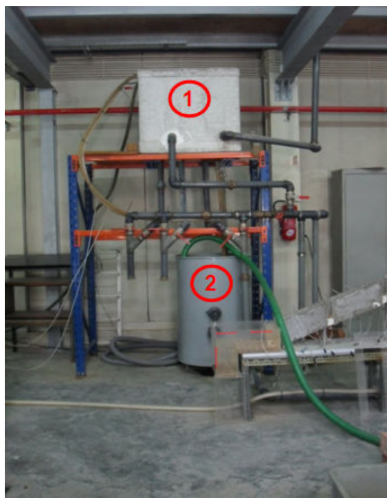
Figura 3.3. - Sistema de alimentação da instalação constituído pelos reservatórios 1 (Reservatório de Alimentação da Instalação) e 2 (Reservatório de Alimentação do Descarregador)
