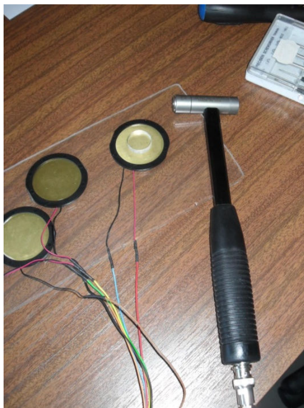
Figura 3.32. - Equipamentos utilizados na calibração das sondas piezo-eléctricas
