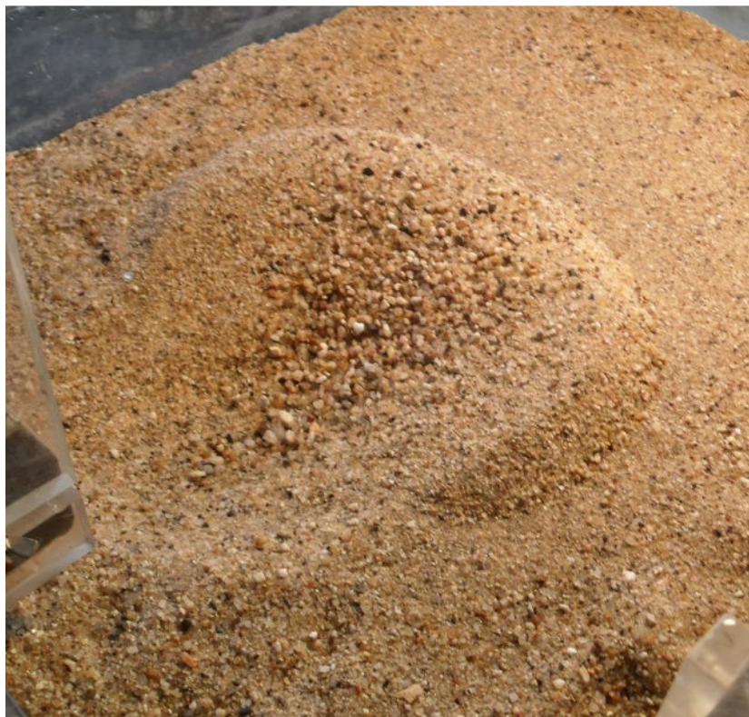
Figura 3.26. - Fossa de erosão com evolução correcta
