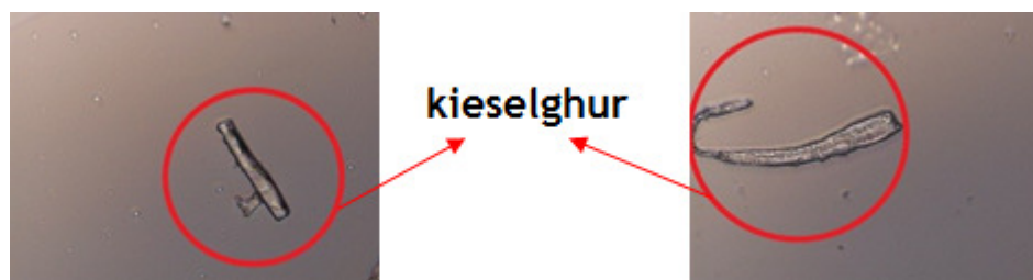
Figura 9 - Fotografias de amostras de cerveja à saída do filtro de KG da linha Orion e Schenk respectivamente, ampliação de 400 X.
