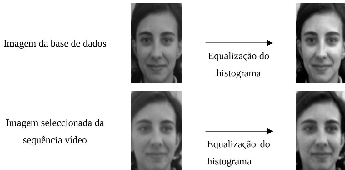
Figura 4.5- Exemplos da aplicação da equalização do histograma. Esquerda - Imagens originais. Direita - Imagens resultado.
