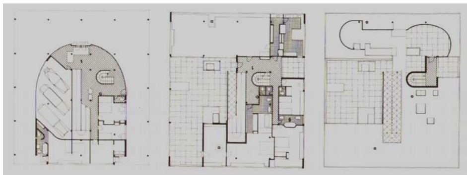
Figura 81 – A utilização de malhas para organização de espaços, por parte de Le Corbusier, procura alcançar “Moléculas arquitectónicas”.
