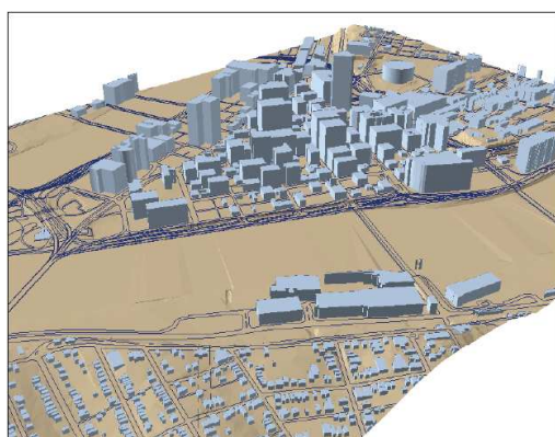
Figura 4.3 - Representação da criação de edifícios sobre um DTM [56].
