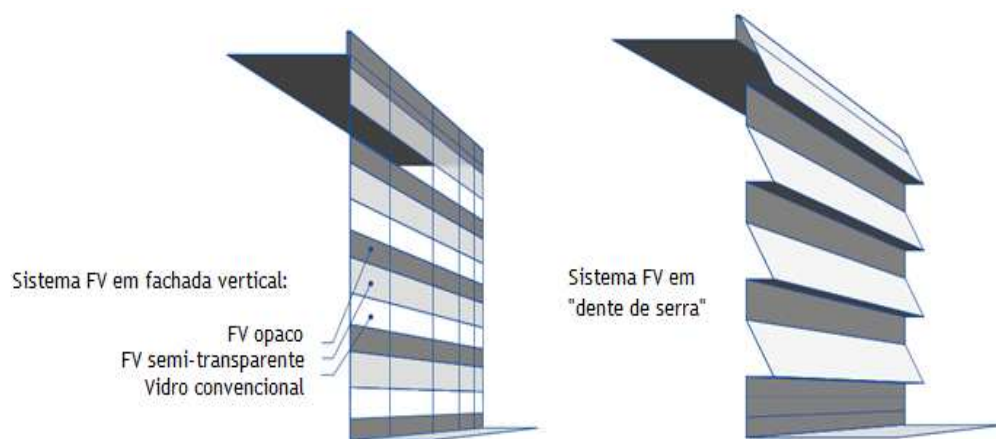
Figura 2.39 - Esquemas de representação de uma fachada na vertical (à esquerda) e do design dente de serra (à direita) [40].
