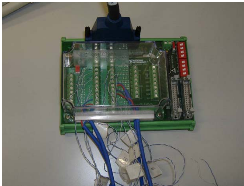
Figura 6 – Placa de circuitos ‘ON-Board’ CJC, modelo TBX 68T.
