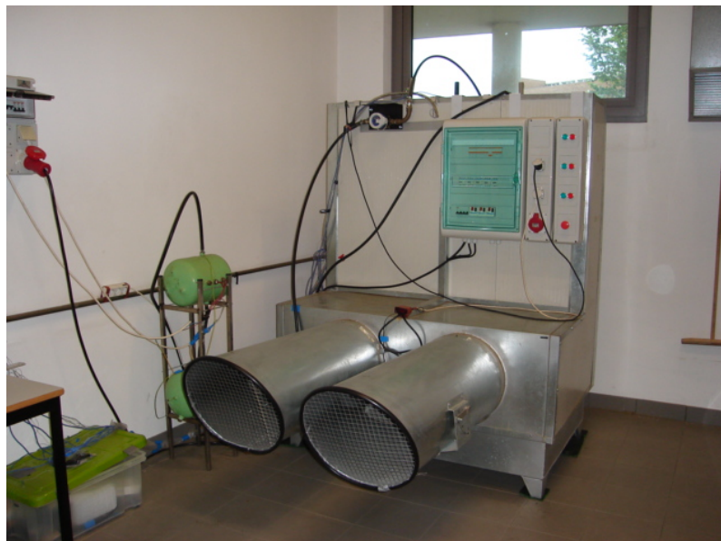
Figura 1 – Torre de Arrefecimento.
