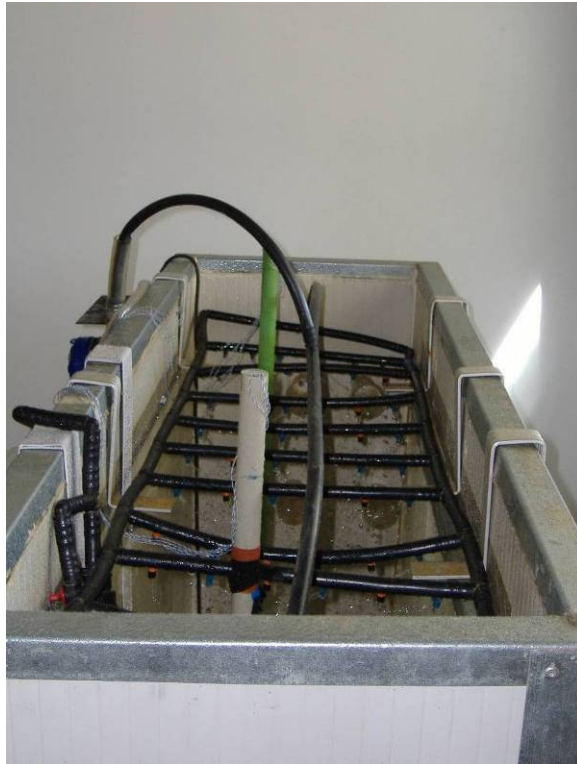
Figura 16 – Aspecto geral da colocação dos termopares e aspersores.
