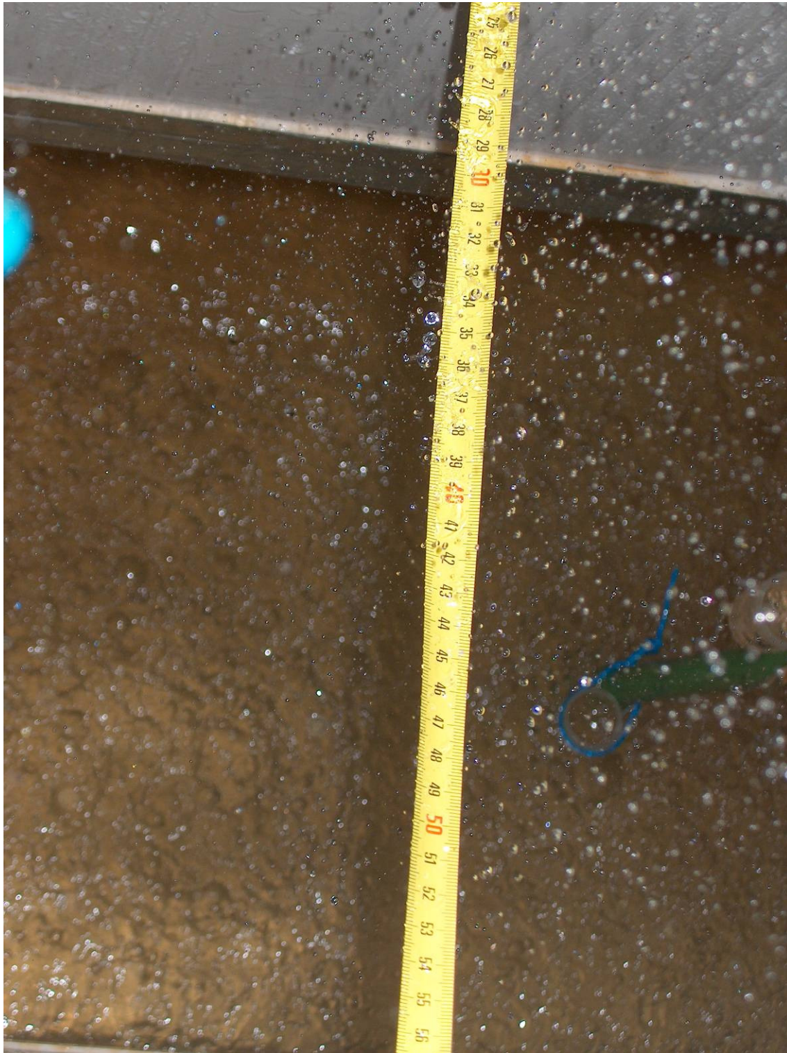
Figura 15 – Fotografia horizontal de gotas de água em queda na torre de arrefecimento, junto aos aspersores. Caudal de água de 0,120 kg/s, caudal de ar de 2,340 kg/s.
