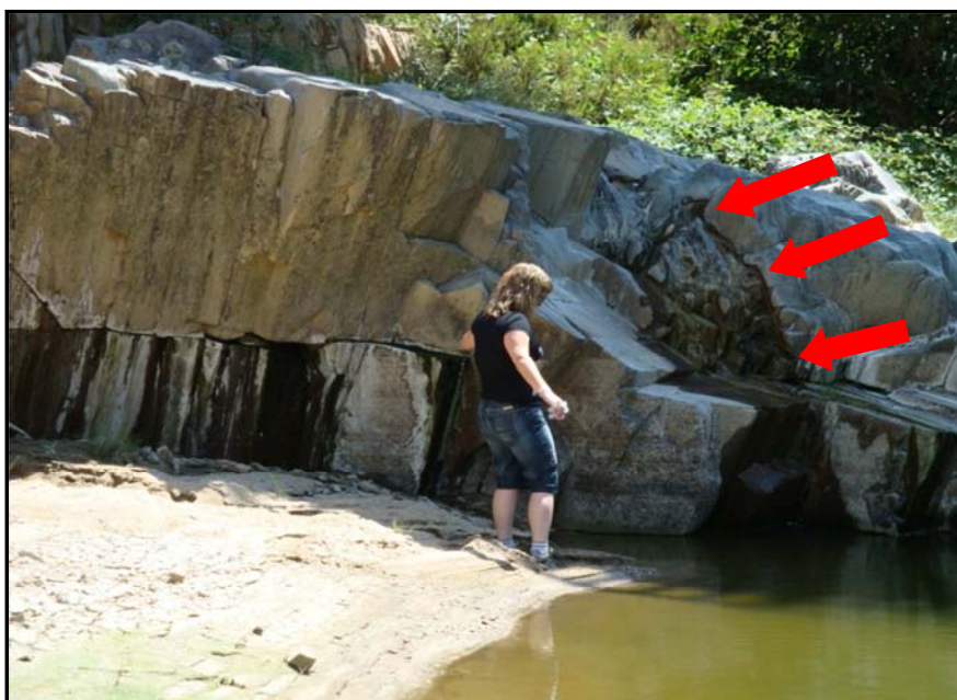
Fig. 62. Amostragem no local A12, em que se destaca a vermelho as escorrências superficiais ácidas para o Rio Zêzere.
