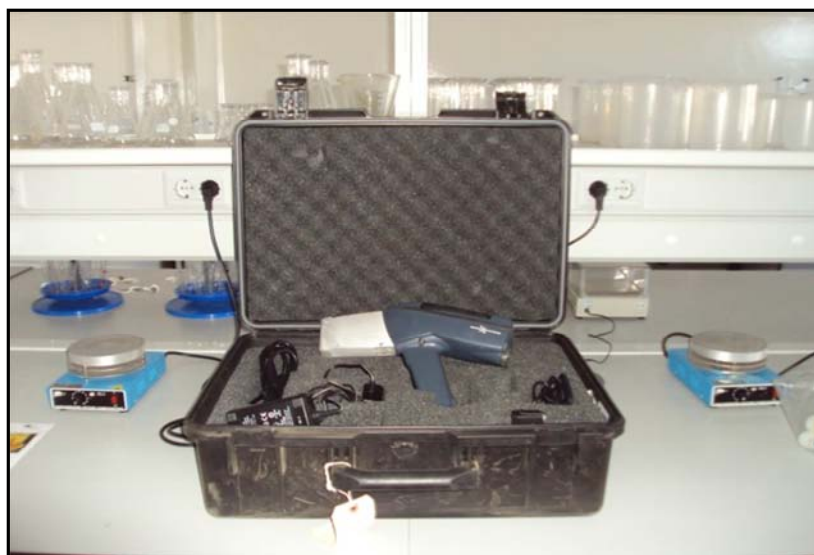
Fig. 24. Analisador Portátil de Fluorescência por Raios X usado na amostragem para leitura das concentrações dos elementos no solo.
