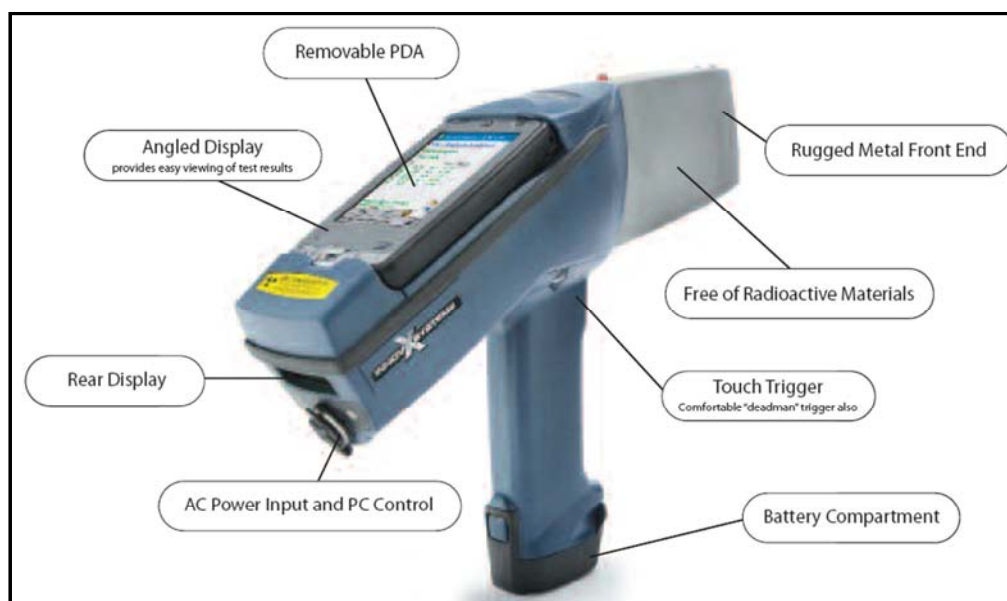
Fig. 28. Modelo um Analisador Portátil de Fluorescência por Raios X com PDA incorporado, e descrição dos seus componentes (fonte: www.innovx.com ).
