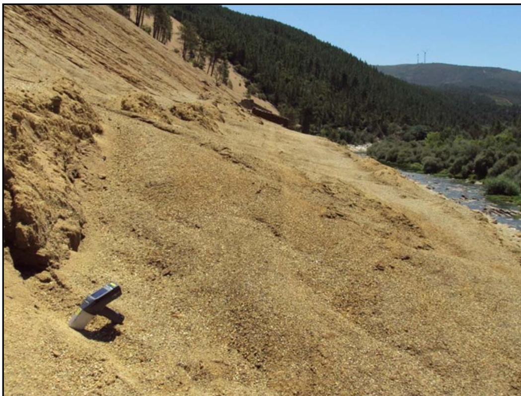
Fig. 42. Amostragem a sul na base da Escombeira junto a BE5, em que é visível uma derrocada de material a recobrir o terraço.
