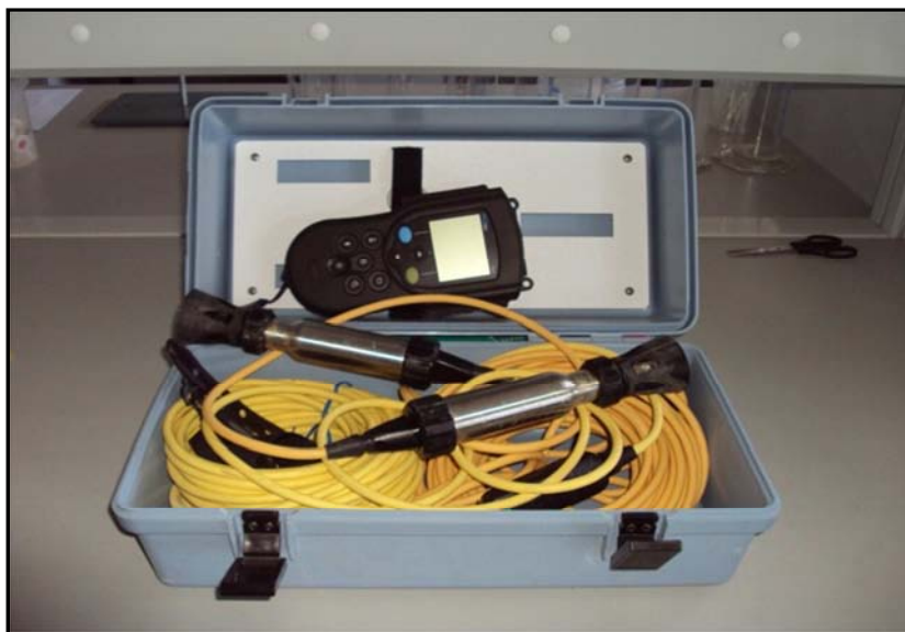
Fig. 23. Sondas usadas na amostragem para mediação do pH e oxigênio dissolvido.
