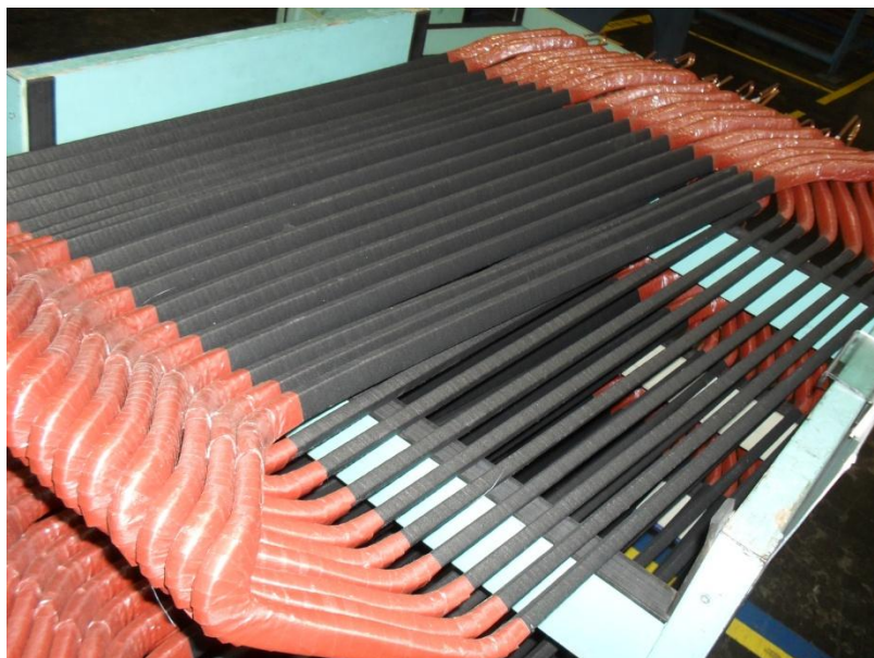
Figura 9. Conjunto de bobinas em forma de trapézio antes de serem inseridas no estator
