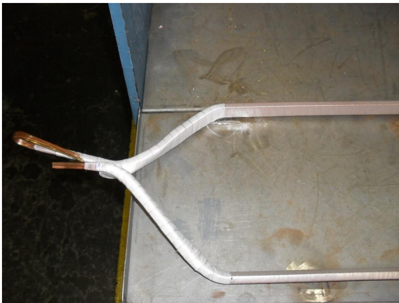
Figura 10. Bobina em Forma de trapézio antes de ser inserida no estator
