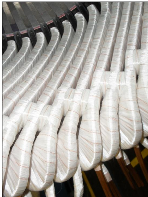
Figura 13. Bobinas inseridas na ranhura de um estator.
