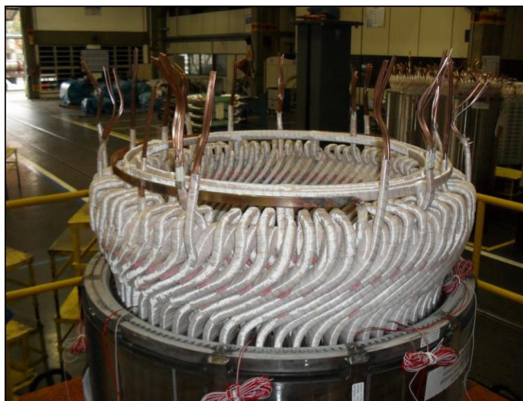
Figura 21. Realização da ligação conforme o esquema de bobinagem
