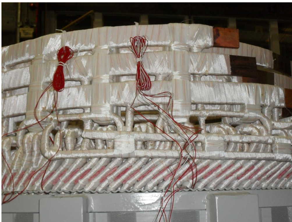
Figura 15. Exemplificação dos PT-100 inseridos no estator
