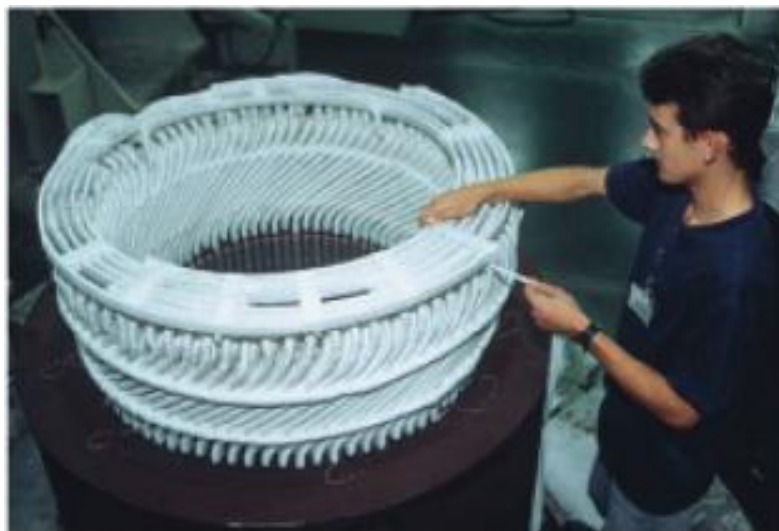
Figura 19. Amarração das cabeças de bobinas
