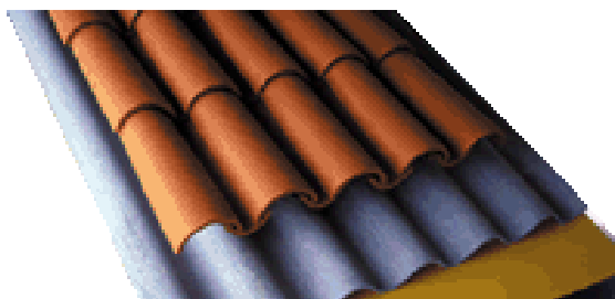
Fig.38 – Telha sobre chapa de naturocimento
