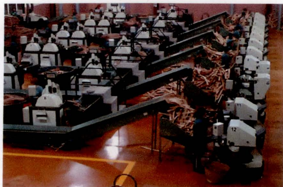
Figura 3.19 – Linha de Corte, Laminagem e Brocagem
