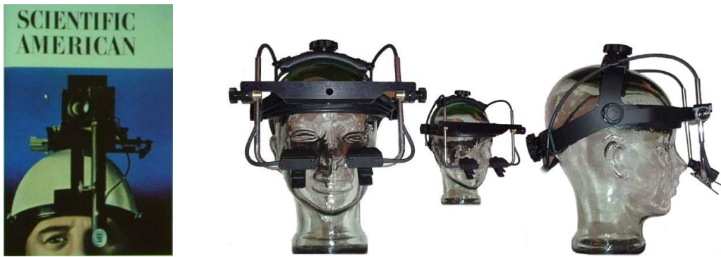
Figura 3: À esquerda, o Eye Tracker desenvolvido por Mackworth e Thomas (1962) baseado numa câmara de cinema de 8 mm. À direita, um exemplo dos sistemas montados na cabeça.
