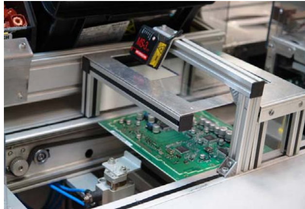
Fig. 4.11 - Controlo de entrada de PCB (leitura código de barras)
