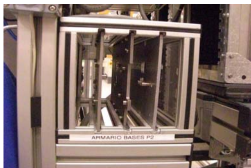
Fig. 4.3 - Armário posto da montagem manual (ausência de espaço para a base que está a ser utilizada)
