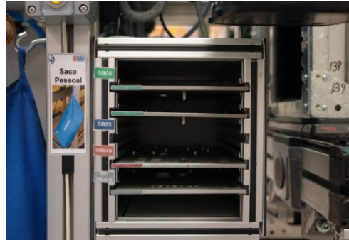
Fig. 4.4 - Gaveta posto da montagem final após redimensionamento (já com uma gestão visual)
