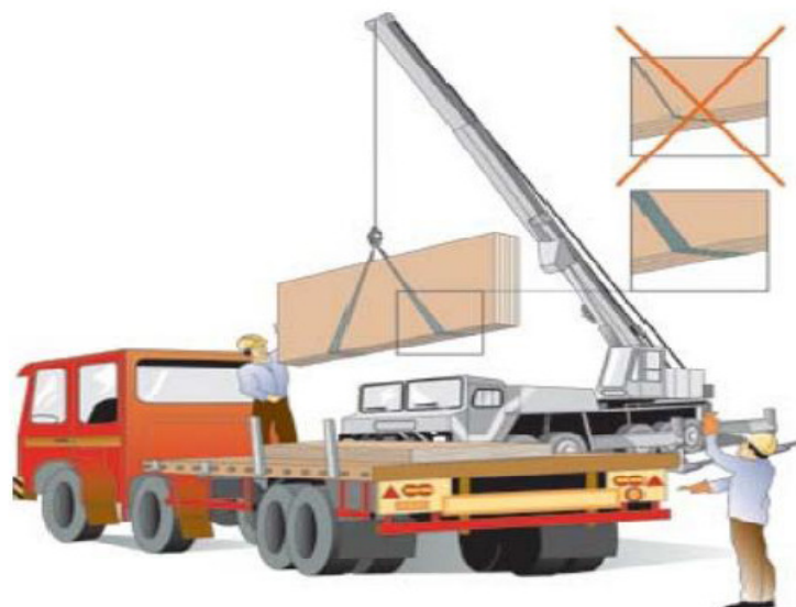
Figura 3.3. – Correcto transporte dos painéis de Viroc. [9]
