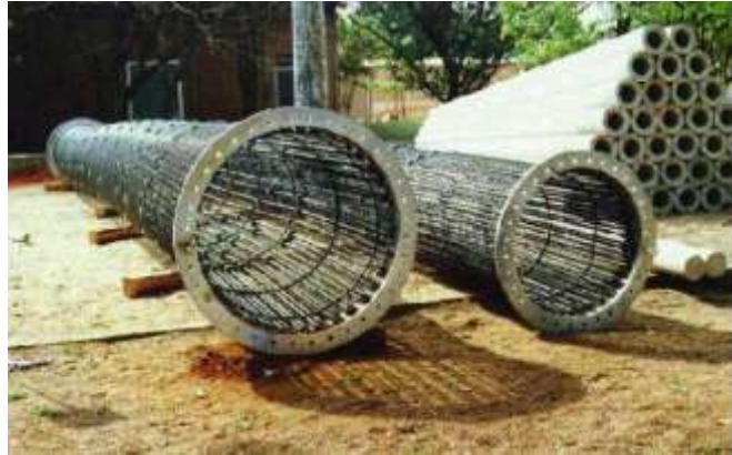
Ilustração 28 Armação para postes de betão usada no Brasil
