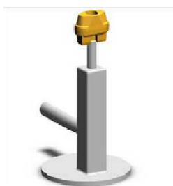
Figura 11: Representação do cadinho fechado de duas cavidades patenteado pela OCC, GmbH [40];
