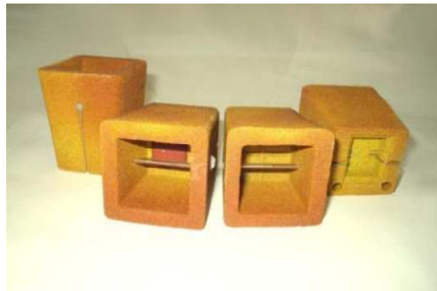
Figura 10: Exemplo de cadinhos abertos de secção quadrada [39];
