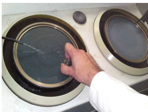
Figura 22: Fotografia durante a operação de polimento manual realizada;
