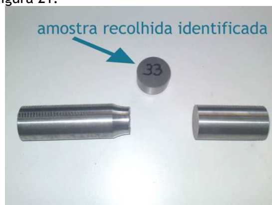
Figura 21: Exemplo da forma de identificação de uma amostra cortada do provete;
