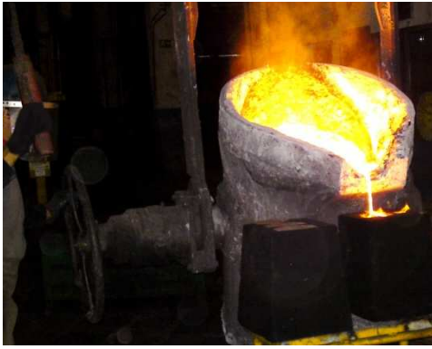
Figuras 17 e 18: Imagem da esquerda, vazamento do tarugo para obtenção de um provete para ensaio de tracção; imagem da direita, moldação em areia, com chapa de identificação para associar o tarugo ao teste realizado;
