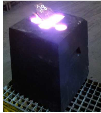
Figuras 17 e 18: Imagem da esquerda, vazamento do tarugo para obtenção de um provete para ensaio de tracção; imagem da direita, moldação em areia, com chapa de identificação para associar o tarugo ao teste realizado;
