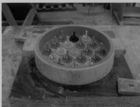
Figura 4. 6 - Aspecto da caixa de moldação montada.
