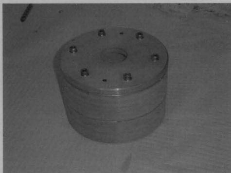
Figura 3. 10 - Aspecto final da ferramenta em resina para o fabrico de silicones.
