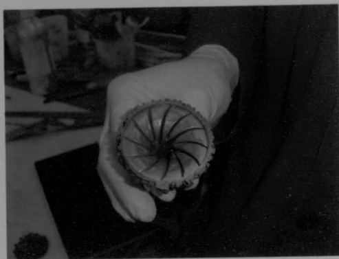
Figura 3.17 - Cavidade em cobre de um impulsor.
