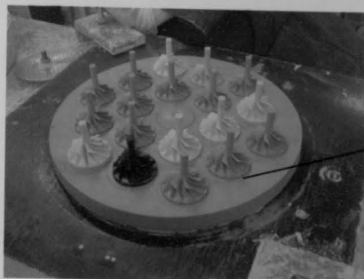
Figura 5. 3 - Placa de moldação montada com os impulsores em silicone.
