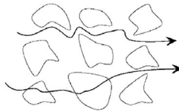
Figura 2.3 Difusão em sólidos porosos (primeira abordagem)
