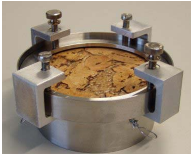
Figura 3.2. Conjunto (copo de difusão com todos os constituintes montados) [38]
