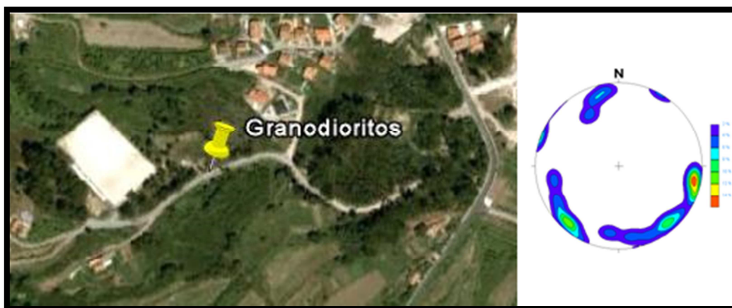
Ilustração 11: Vista aérea do local do afloramento granodiorítico (Google Earth) e respectivo diagrama de densidade de pólos para os planos de diáclases (n=20). Reconhecem-se duas famílias de fracturas, como orientações gerais NNW – SSE a NW – SE subvertical e uma NE – SW subvertical.
