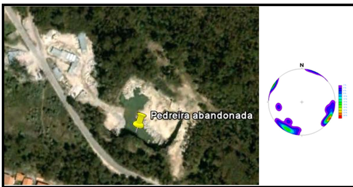
Ilustração 13: Vista aérea da pedreira abandonada em Cabeça Santa (Google Earth) e respectivo diagrama de densidade de pólos para os planos de diáclases (n=22). Reconhecem-se duas famílias de fracturas, como orientações gerais NE – SW subvertical e uma NW – SE subvertical.
