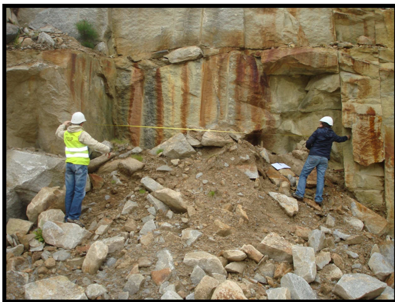
Ilustração 9: Medição do espaçamento entre duas fracturas – Pedreira da Costa Queimada
