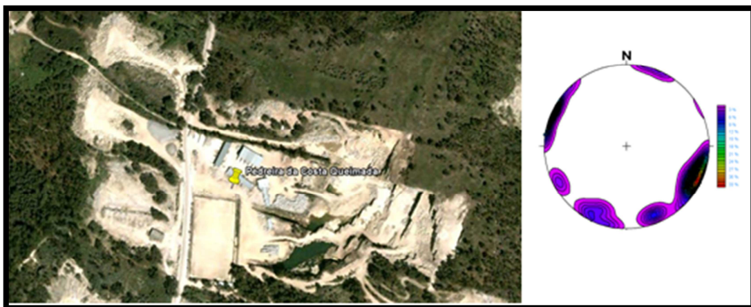
Ilustração 17: Vista aérea da Pedreira da Costa Queimada (Google Earth) e respectivo diagrama de densidade de pólos para os planos de diaclases (n=29). Reconhecem-se duas famílias de fracturas, como orientações gerais NNW – SSE a NW – SE subvertical e uma NNE – SSW a NE – SW subvertical.
