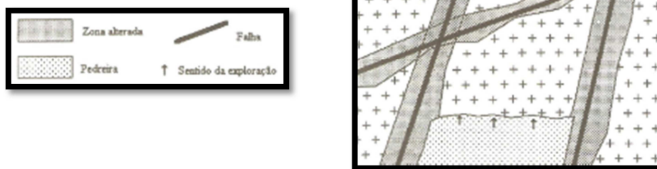
Ilustração 3: Localização das pedreiras e evolução da exploração condicionadas pelos corredores de fracturação (Sousa et al. , 1998).
