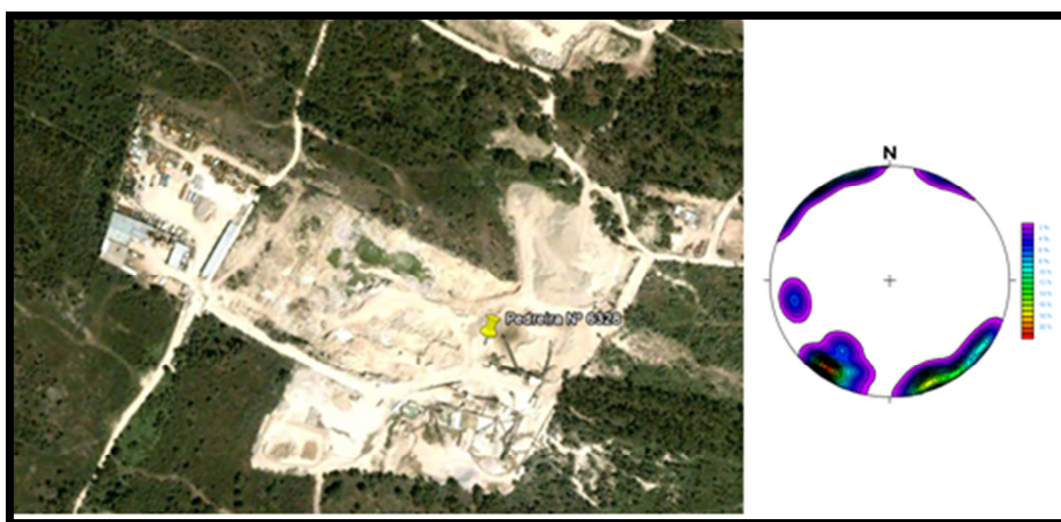
Ilustração 21: Vista aérea da pedreira nº 6328 (Google Earth) e respectivo diagrama de densidade de pólos para os planos de diáclases (n=8). Reconhecem-se duas famílias de fracturas, com orientações gerais NNW – SSE a NW – SE subvertical e uma NE – SW subvertical.
