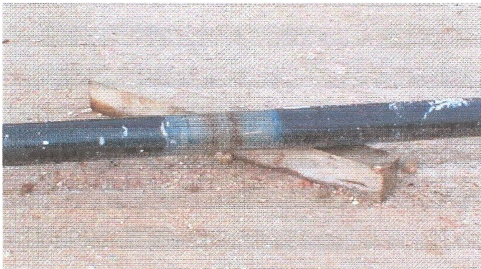
Figura 3 – Cordão de soldadura de uma rede em aço
