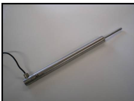
Figura 3.1 – Fotografia de um LVDT
