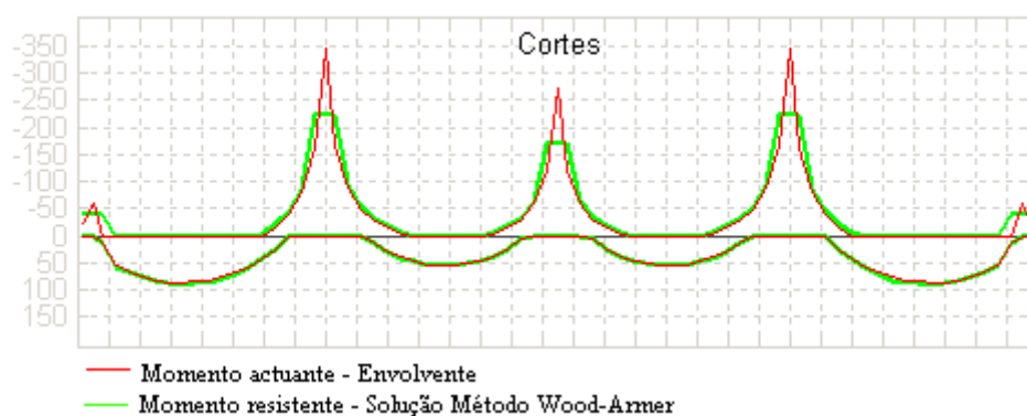
Figura 6.17 - Corte longitudinal no eixo dos pilares centrais (direcção xx ) – obtido com a 2ª aplicação [kN.m/m].
