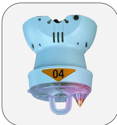
Figura 5.7 - Indicador de Passagem de Defeito monofásico para instalação na linha, Flite 110-SA / Flite 116-SA
