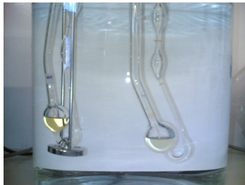
Figura 24 - Viscosímetros com amostra de Diesel e Biodiesel Feup no banho termoestático
