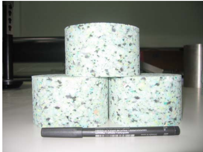
Figura 4.8 - Material de teste: Aglomerado de desperdícios de espumas de poliuretano recicladas
