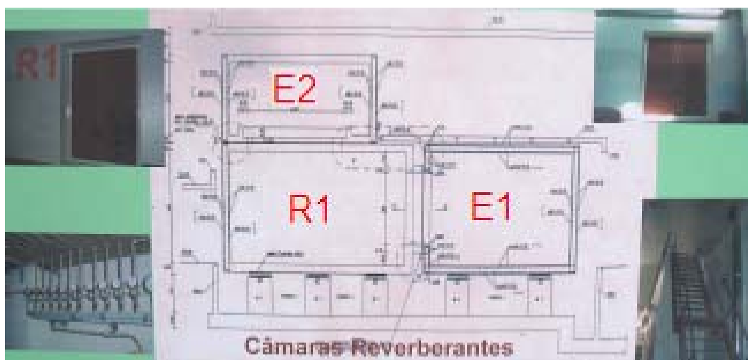
Figura 4.15 - Esquema das Câmaras Reverberantes - Corte transversal
