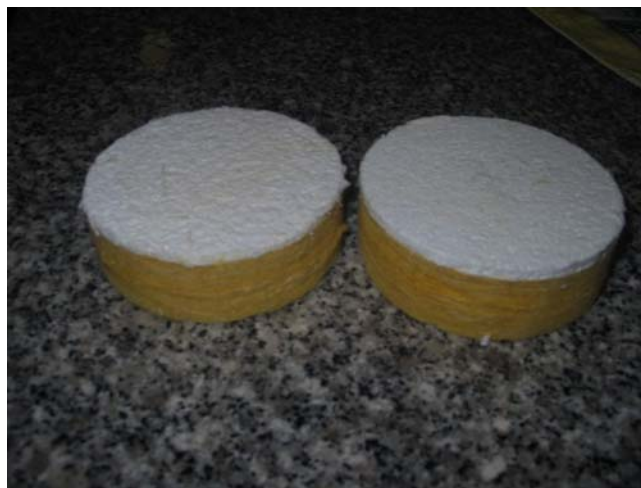
Figura 1.1 - Material projectado (à esquerda) e material Talochado (à direita)
