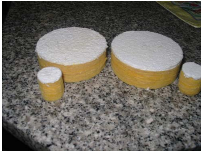
Figura 4.11 - Amostras estudadas no tubo de ondas de estacionárias: material Projectado (à esquerda); material Talochado (à direita)
