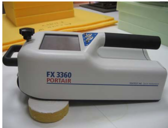
Figura 4.2 - Medição da resistência à passagem do ar
