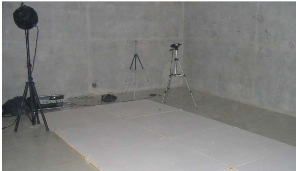
Figura 4.17 - Foto do ensaio do Material Talochado na Câmara Reverberante
