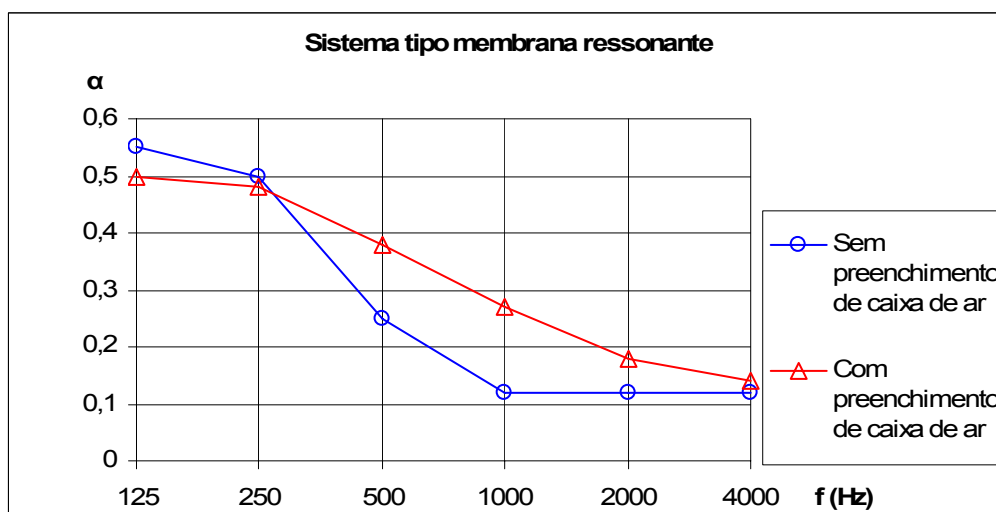
Figura 2.10 - Valores do coeficiente de absorção sonora de sistemas tipo membrana ressonante [9]
