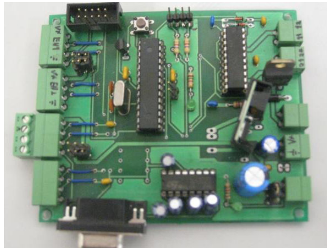
Figura 3.14 - Módulo Generic ATmega8 .
