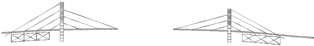
Figura 8.6- Montagem dos módulos centrais do tabuleiro, III;
