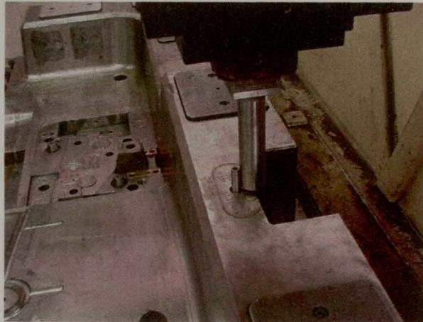
Figura 48 – Foto do centramento numa máquina de erosão.
