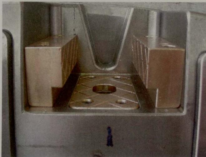
Figura 57 – Foto dos acessórios usados para o deslize de um movimento
