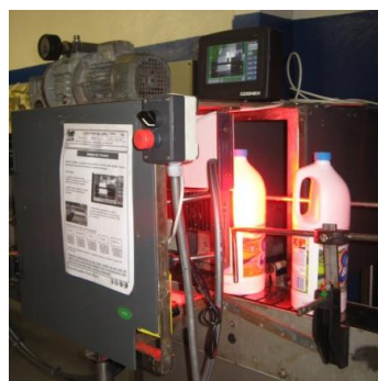
Figura 35 – Câmara Instalada na Linha
